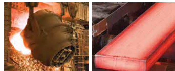
▲製鋼:転炉で不純物の除去・用途に応じた成分調整 ▲製鋼:連続鋳造設備で冷やし固められたスラブ
