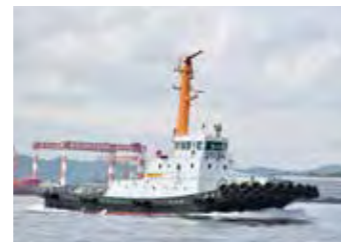
就役 2019年6月 防災曳船 千葉丸 総トン数 255t 出力 4,400PS 速力 14.5ノット
