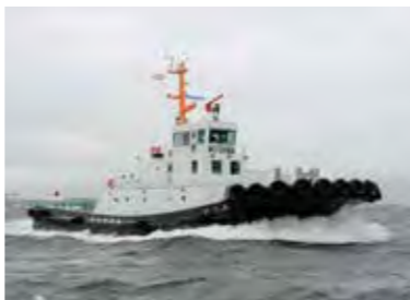
就役 2015年9月 防災曳船 みつば 総トン数 193t 出力 3,600PS 速力 14.2ノット
