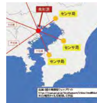
▲妨害電波の到来方向の確認画面のイメージ 各センサ局で妨害電波の到来方向を感知し、その方向に引いた線の交点から妨害源の位置を推定します。
