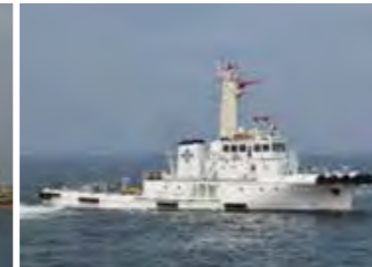
就役 2001年12月 化学消防船 きよたき (一財)海上災害防止センター殿 所有 総トン数 263t 出力 3,600PS 速力 16.0ノット
