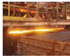
▲焼結炉:鉄鉱石とコークス・石炭を混ぜて焼き固める
