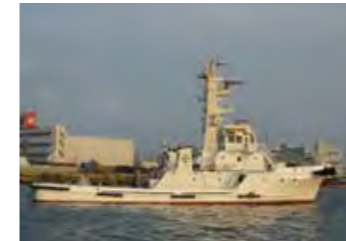
就役 1996年3月 化学消防船 おおたき (一財)海上災害防止センター殿 所有 総トン数 199t 出力 3,600PS 速力 15.3ノット
