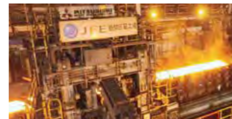
▲熱間圧延:圧延ロールを通過し薄く伸ばされる鋼板
