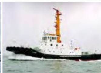
就役 2005年6月 防災曳船 成田丸 総トン数 257t 出力 4,000PS 速力 14.6ノット
