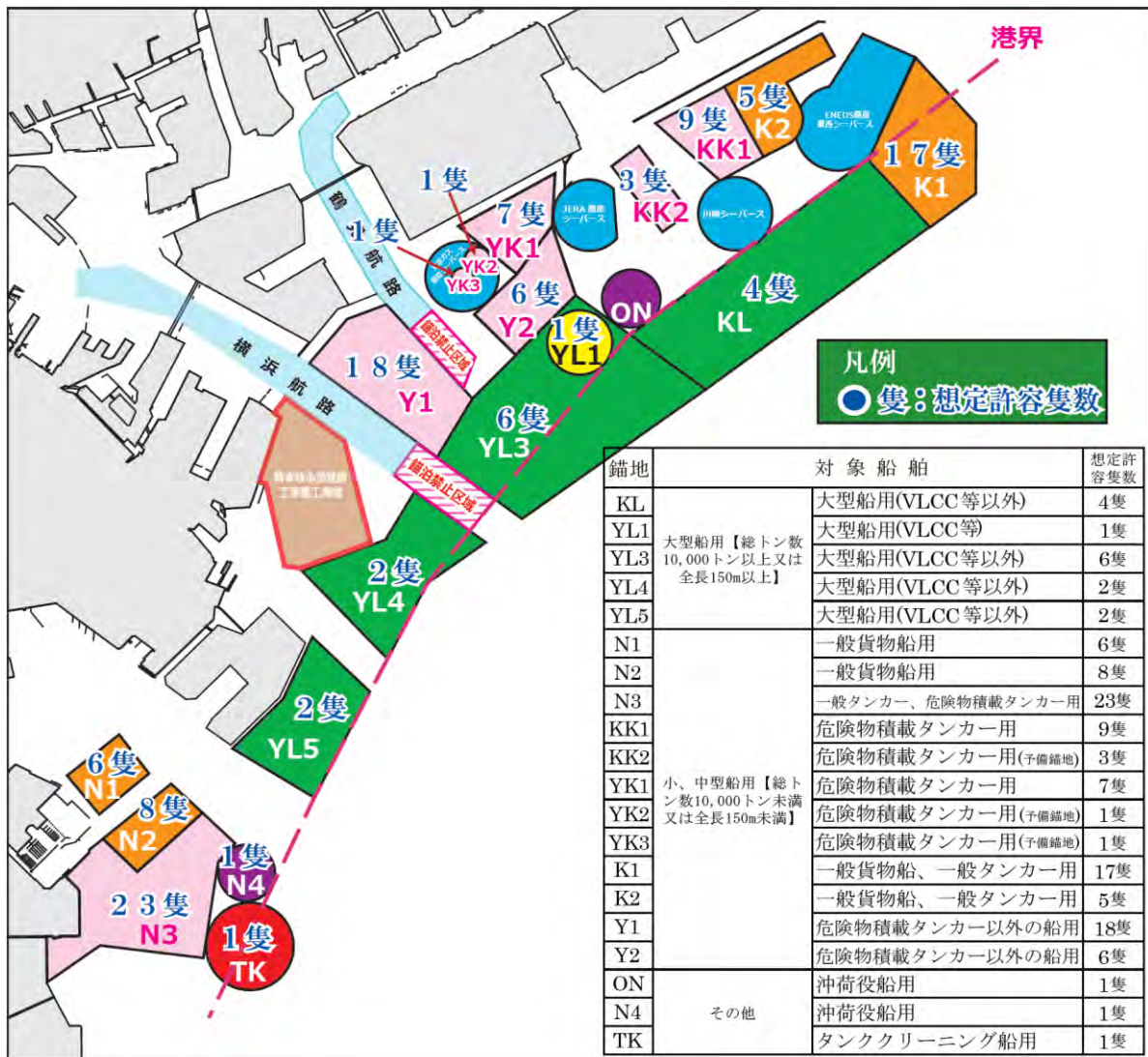
図 9.4.1 錨地配置及び各錨地の想定許容隻数（令和元年 11 月 11 日から）
