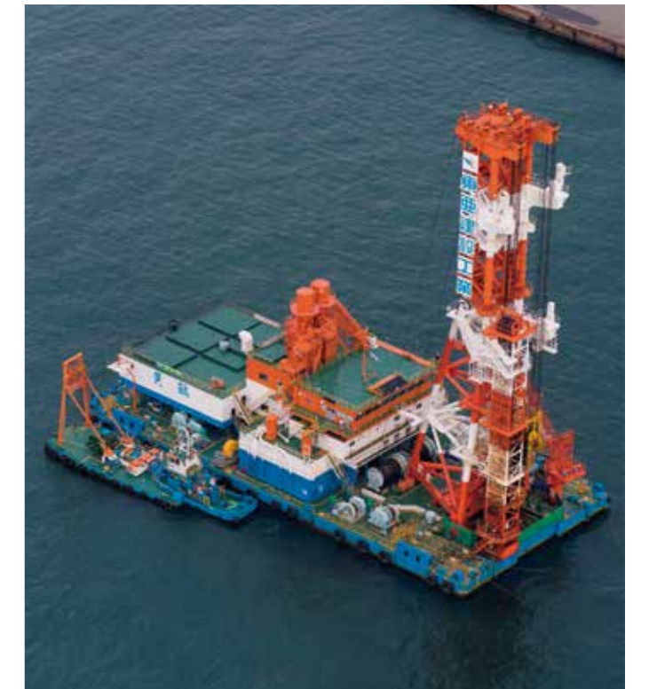
▲深層混合処理船 黄鶴(2010年建造)
