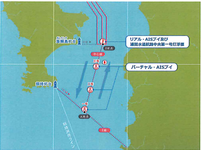
▲図1:バーチャル・AISブイの設置状況
