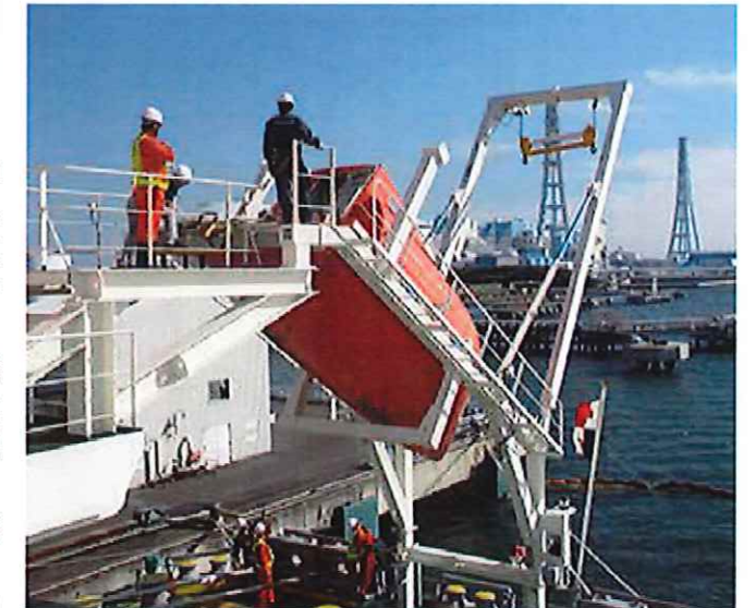
▲救命艇の点検検査・整備
