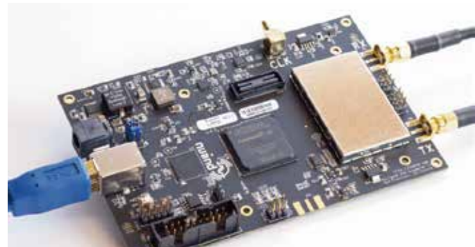
▲(図4) ソフトウェア無線デバイス(bladeRF)
