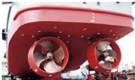
▲特殊なプロペラ(Z-Drive-Propeller)
