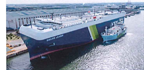
▲LNG燃料バンカリング船「かぐや」から本邦初のLNG燃料自動車専用船「SAKURA LEADER」への燃料供給の様子 (日本郵船プレスリリースより抜粋)
