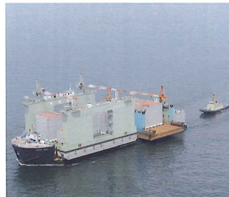
▲半潜水式台船による東京湾からグム向け作業船回輸送
