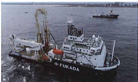
▲多目的作業船「POSEIDON-1」(写真手前)と「新潮丸」(写真奥)による地盤調査
