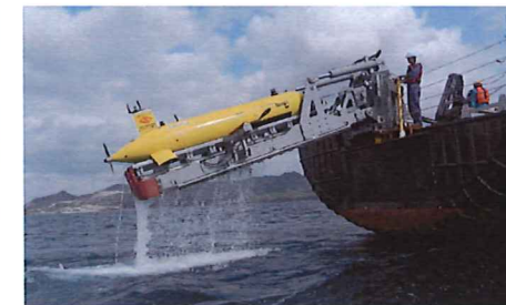
▲AUV(自律式無人潜水機)による海底地形調査
