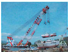
▲大型起重機船「富士」(3,000トン吊)による漁船の救助作業
