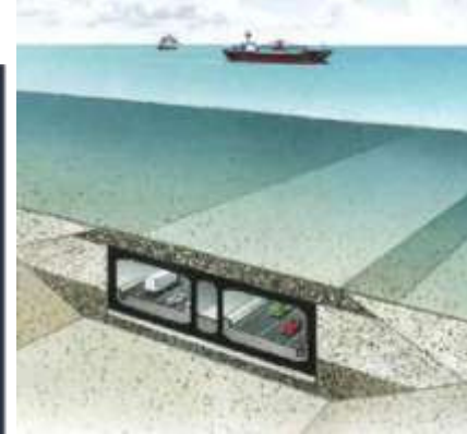
東京港海の森トンネル 沈埋トンネル部（直轄）
